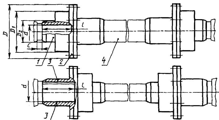
1 — втулка; 2 — обойма; 3 — фланцевая полумуфта; 4 — промежуточный вал
